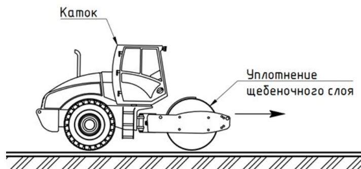
Схема уплотнения щебеночного слоя (Схема показана условно, применяемые машины могут быть заменены)
