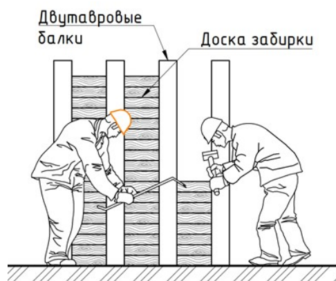
Схема установки досок в проектное положение
