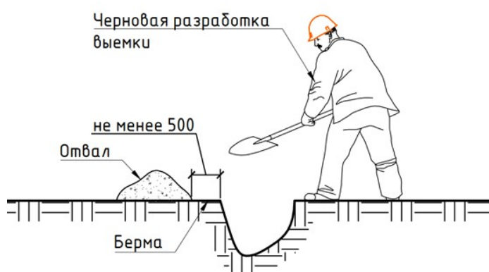
Схема разработки грунта вручную
