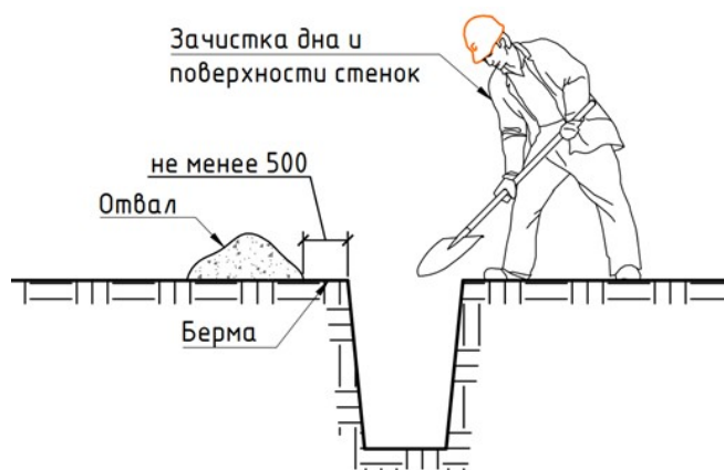
Схема зачистки выемки до проектных размеров
