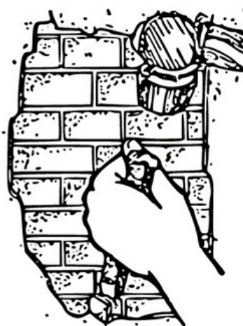
Схема демонтажа штукатурки при помощи зубила (Схема показана условно)
