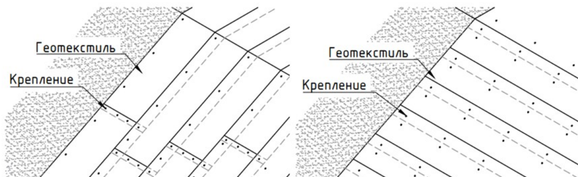
Схема поперечной (слева) и продольной (справа) укладки геополотен (Схема показана условно)
