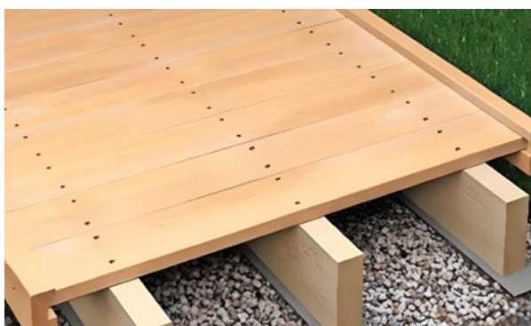
Схема устройства готового деревянного тротуара
