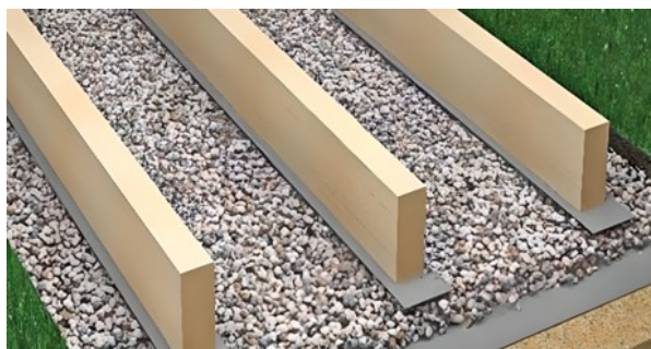
Схема укладки лаг (Подстилающие слои показаны условно)
