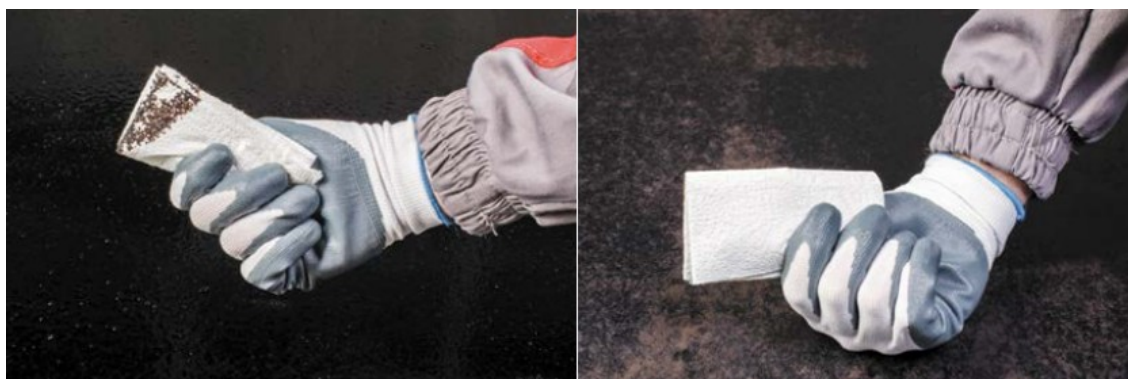
Проверка высыхания праймера
