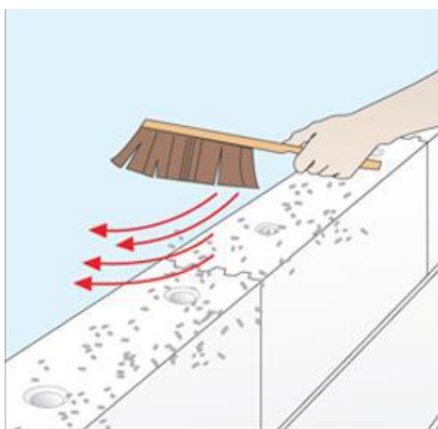
Рисунок 29 – Очистка от грязи и пыли поверхности уложенных элементов кладки перед нанесением раствора или клея
