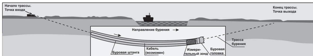
Рисунок 8.3 – Направленное бурение пилотной скважины
