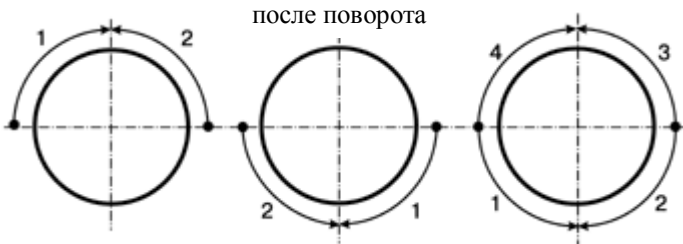
Рис. 5. Сварка в поворотном стыке труб корневого шва в два поворота двумя сварщиками: 1–4 – последовательность выполнения шва
