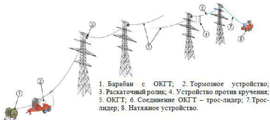
Рисунок 7.4.1 Типовая схема монтажа ОК на ВЛ
