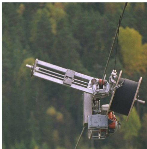
Рисунок 7.4.2 Навивная машинка шпиндельного типа
