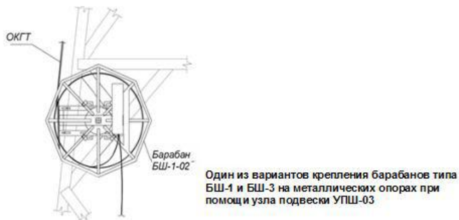
Рисунок 4.13.4 Схема крепления муфты МОПГ-М с барабанами БШ на решетчатых опорах ВЛ
