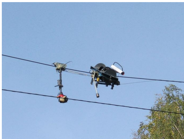
Рисунок 7.4.3 Навивная машинка рамного типа
