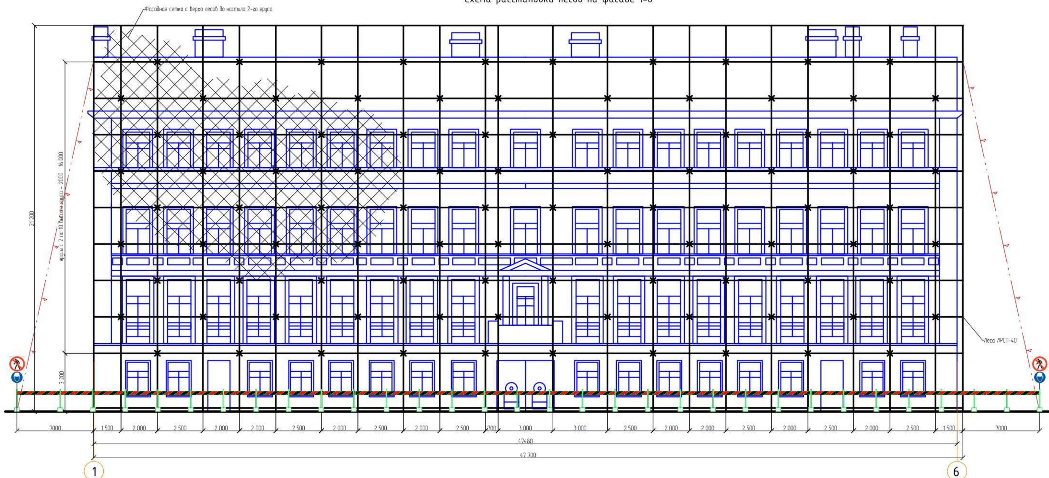
Схема расстановки лесов на фасаде 1-6
