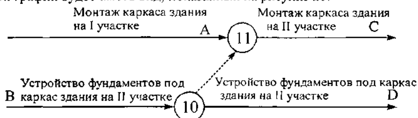
Рисунок 20 – Параллельное выполнение работ А, С и В, D с фиктивной работой 10-11
